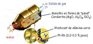
Convertidor catalítico en motores de gasolina
